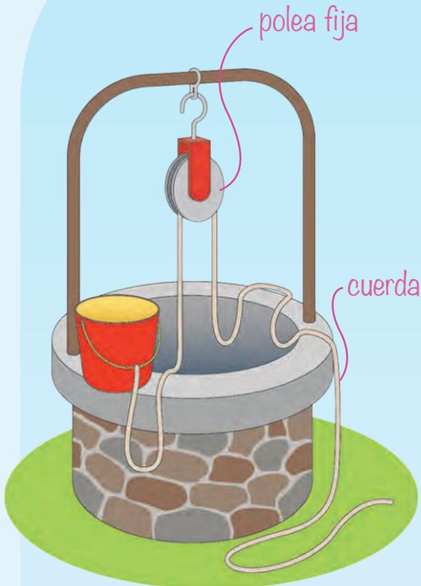
La polea es una máquina simple que ayuda a reducir la fuerza que se necesita para mover un objeto. Se compone de una rueda acanalada, por la que pasa una cuerda que gira sobre un eje central.
