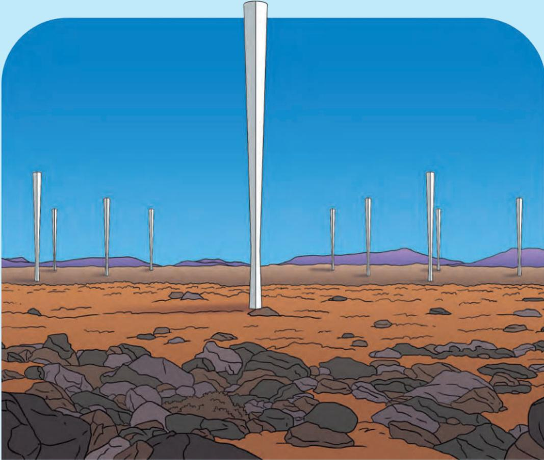
Los aerogeneradores sin aspas son cilindros cónicos verticales que se anclan al suelo con una varilla elástica. Cuando el aire pasa alrededor, produce un balanceo y un sistema de bobinas e imanes permite que este movimiento genere electricidad.
