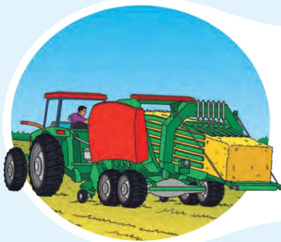
La empacadora es una máquina agrícola que recoge el heno o la paja y los envía a un dispositivo de prensado, en el que son comprimidos, cortados y empaquetados en pacas o fardos. Luego, la máquina amarra los fardos y los arroja al suelo.
