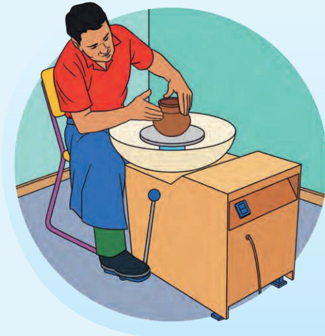
Algunos tornos son eléctricos y están diseñados especialmente para realizar modelados de cerámicas altas y grandes. La velocidad de giro se regula con una palanca pedal, que puede controlarse con el pie o con la mano.
