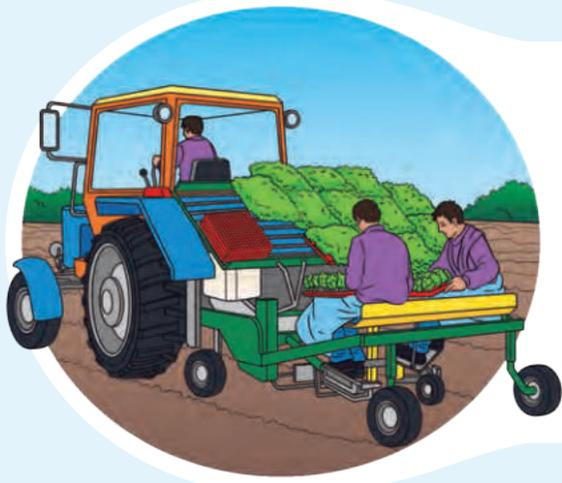
En la máquina trasplantadora, una persona que está sentada va colocando las plántulas en un compartimiento distribuidor. Este vehículo las pone en los surcos y las cubre con un poco de tierra.
